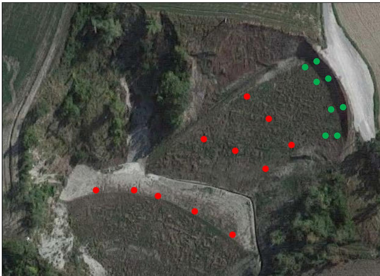
Figura 17: Ortofoto google heart 2018. Posizionamento degli strumenti, in verde i tiltometri, in rosso i prismi
