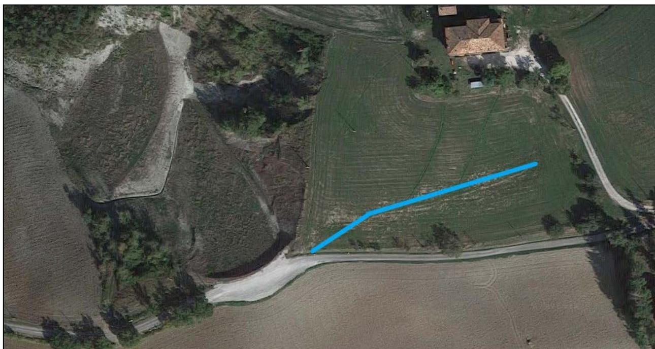
Figura 22: Ortofoto google heart 2018, in azzurro il tracciato della trincea drenante che scarica nel pozzetto di figura 23
