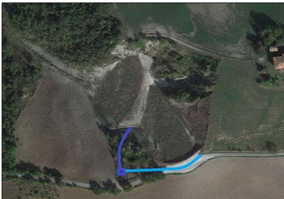
Figura 21: andamento planimetrico della trincea e del suo intubamento (blu scuro preceduto da pozzetto) per scaricarlo nella rete di regimazione superficiale già esistente.
