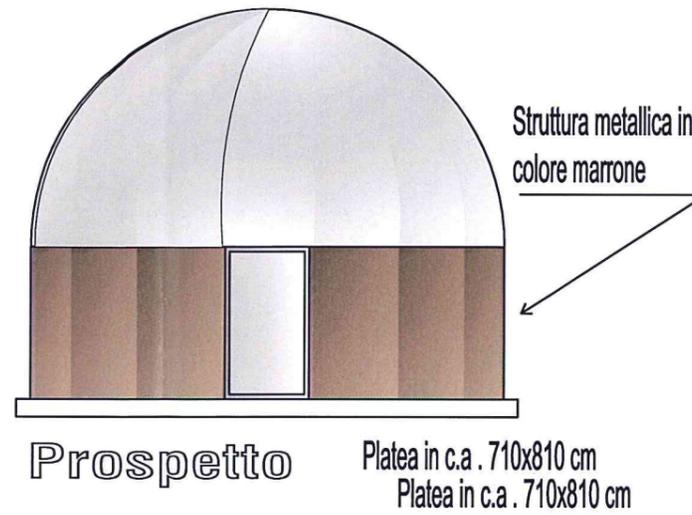
Cupola in struttura metallica  $\varnothing$  600 cm:
