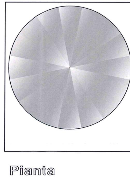
Cupola in struttura metallica  $\varnothing$  600 cm:
